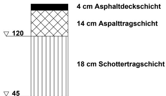
In stark belasteten Fahrspuren, wie z.B. Busspuren oder Stauräumen vor Kreuzungen sind Sonderbauweisen erforderlich ( Abstimmung mit dem FB5 Straßen und Kanäle erforderlich!)
